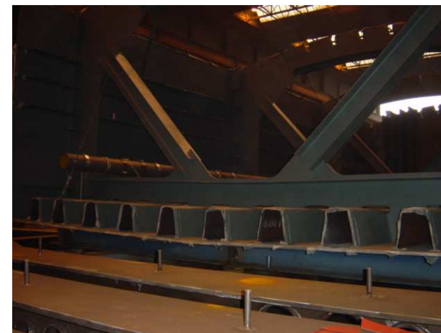
Photo 1 : Vue (retournée) du raidissage interne du tablier
