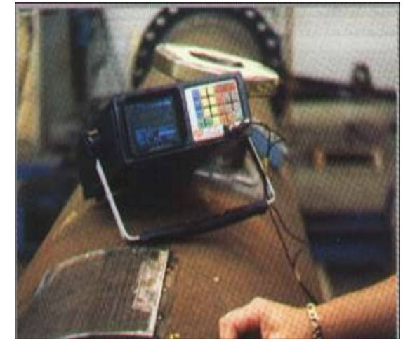
Contrôle US soudure circulaire
